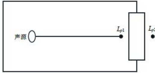
图 4-1 室内声源等效为室外声源图例
